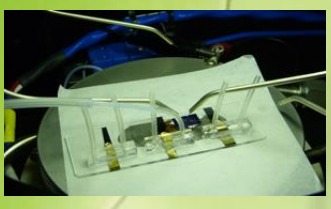
14: 測定装置にセットした流路つきバイオセンサー
